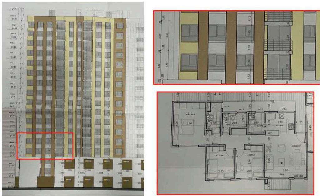
Las dimensiones de las ventanas de las alcobas tienen una medida aproximada de 1.40m x 1.40m, a una altura del piso de 1.12m, lo cual cumpliría con las especificaciones del Acuerdo 20 de 1995, asegurando que se satisfacen los requisitos para iluminación y ventilación adecuados según lo estipulado.
