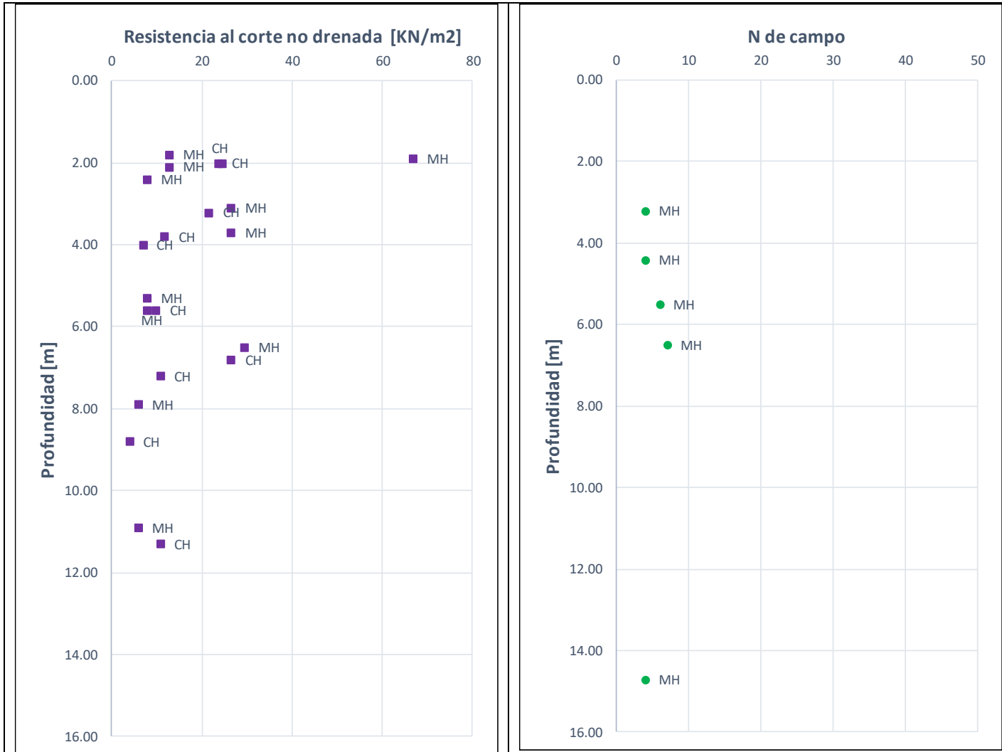
Figura 147 Variación de resistencia al corte - AV. JORGE URIBE BOTERO ENTRE CALLE 210 Y CALLE 222 - TRAMO 1
