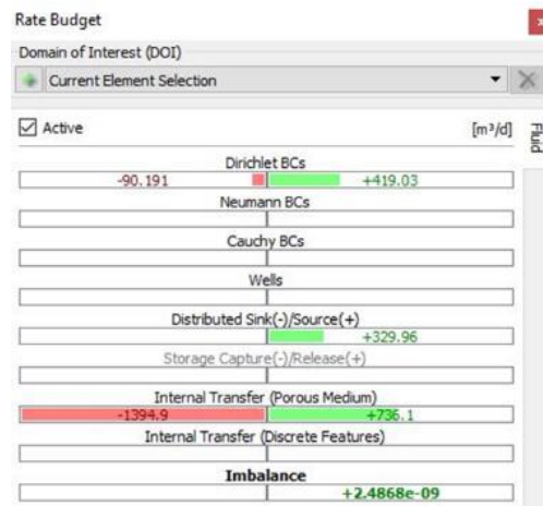
Figura 311 Balance de masas en estado estacionario - Humedal
