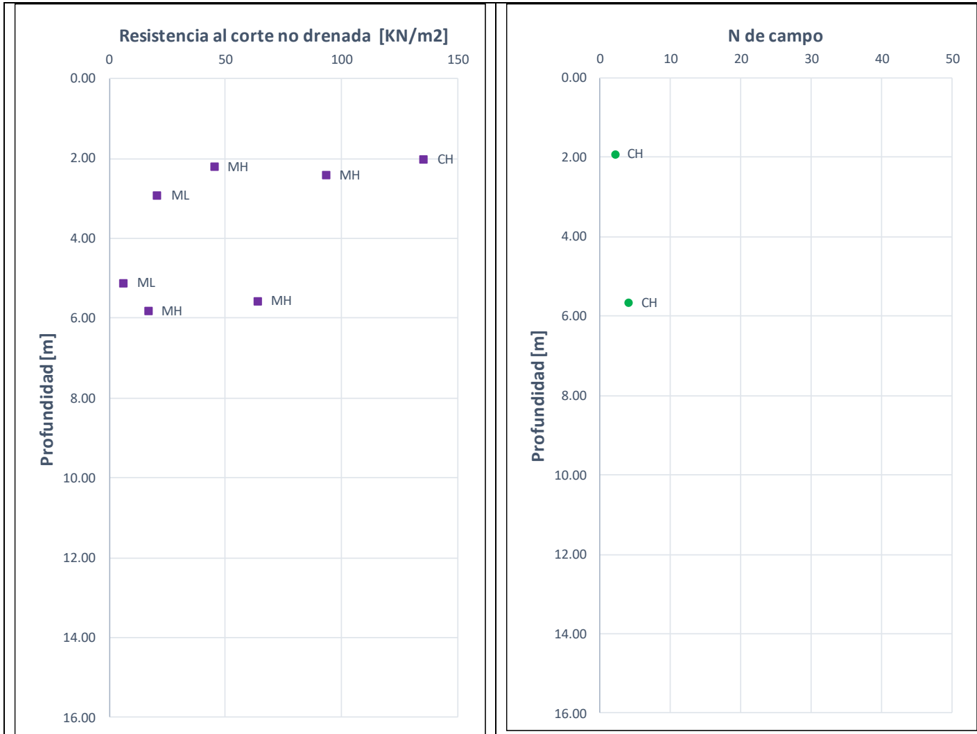
Figura 114 Variación de resistencia al corte - CRA. 9 ENTRE CALLE 200 Y CALLE 210
