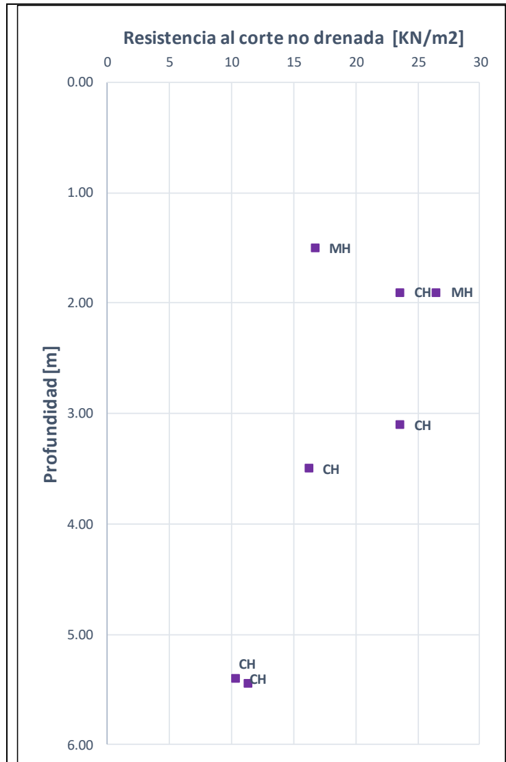
Figura 78 Variación de resistencia al corte - CRA. 15 ENTRE DIAGONAL 192 Y CALLE 200
