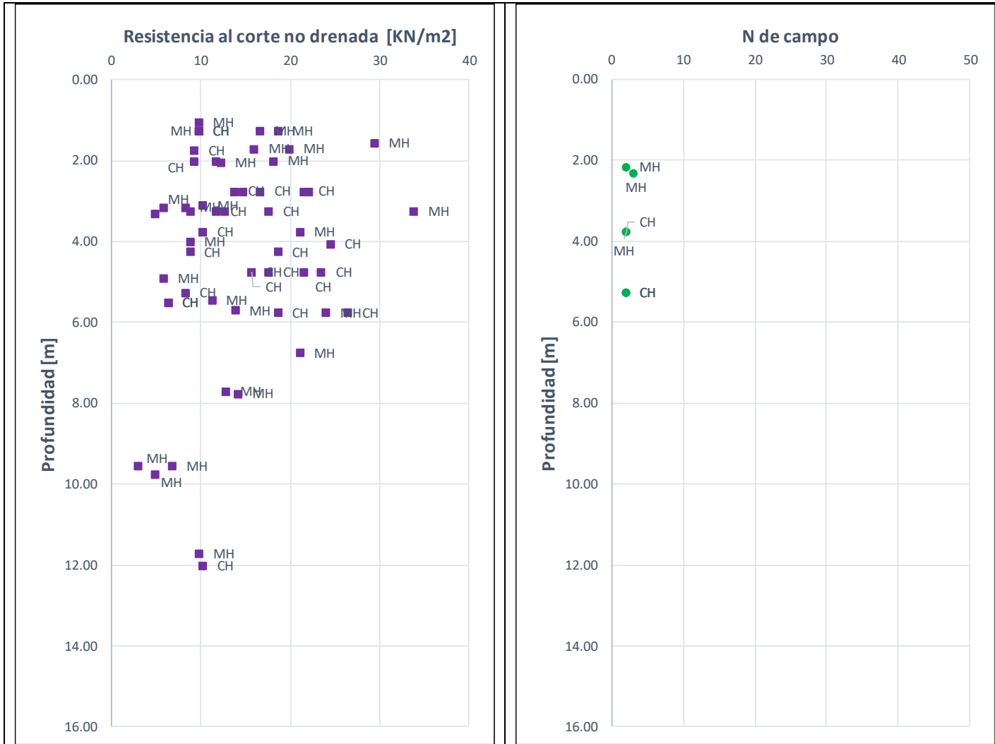
Figura 45 Variación de resistencia al corte - CALLE 184 ENTRE AV BOYACÁ Y AUTOPISTA NORTE
