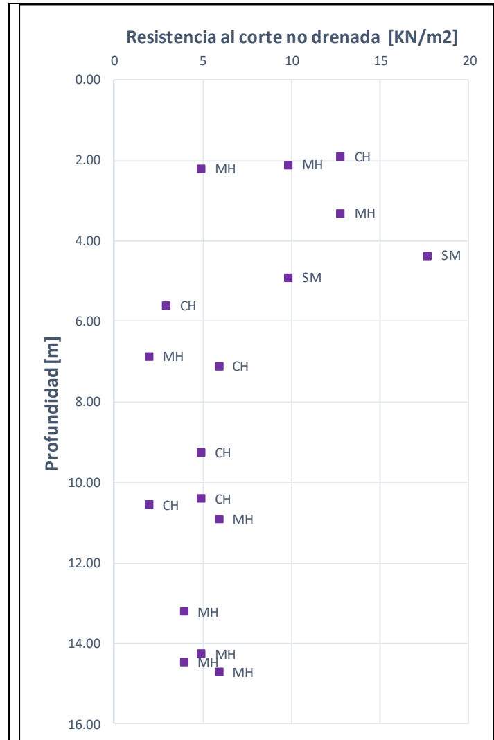
Figura 156 Variación de resistencia al corte - AV. LOW MURTRA. ENTRE AV. POLO (CL 200) Y AV. ARRAYANES (CL 210).
