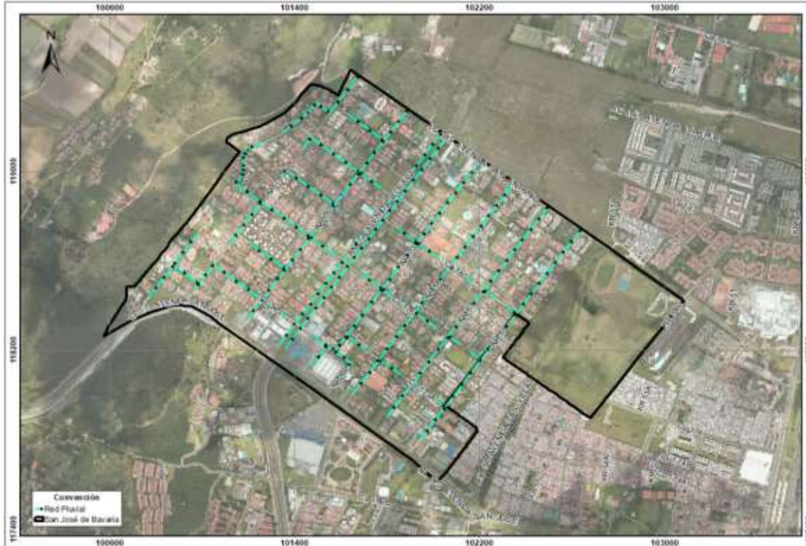
Figura 67 Esquema de Drenaje San José de Bavaria, Proyecto 32462
