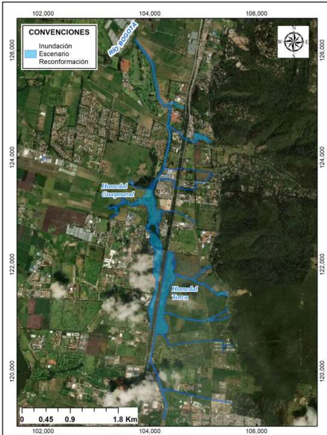
Figura 160 Representación general de la elevación del nivel del agua del Sistema Hídrico Torca Guaymaral – Condición Futura con Adecuación Geomorfológica
