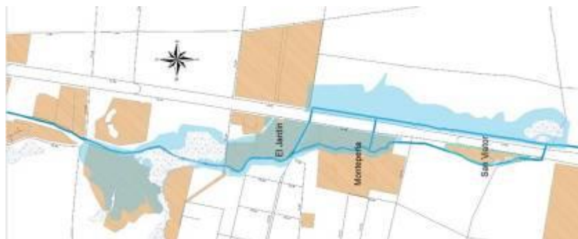
Figura 62. Amojonamientos y rellenos del humedal Torca – Guaymaral. En color azul: amojonamiento del humedal según EAAB. En color naranja achurado: rellenos. Línea azul: canal Torca – Guaymaral. Líneas negras: malla vial.
