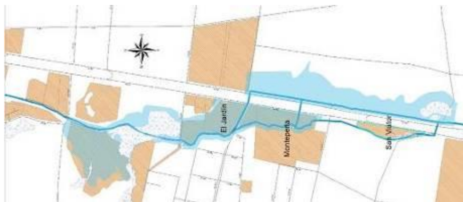
Figura 78 Amojonamientos y rellenos del humedal Torca – Guaymaral. En color azul: amojonamiento del humedal según EAAB. En color naranja achurado: rellenos. Línea azul: canal Torca – Guaymaral. Líneas negras: malla vial.
