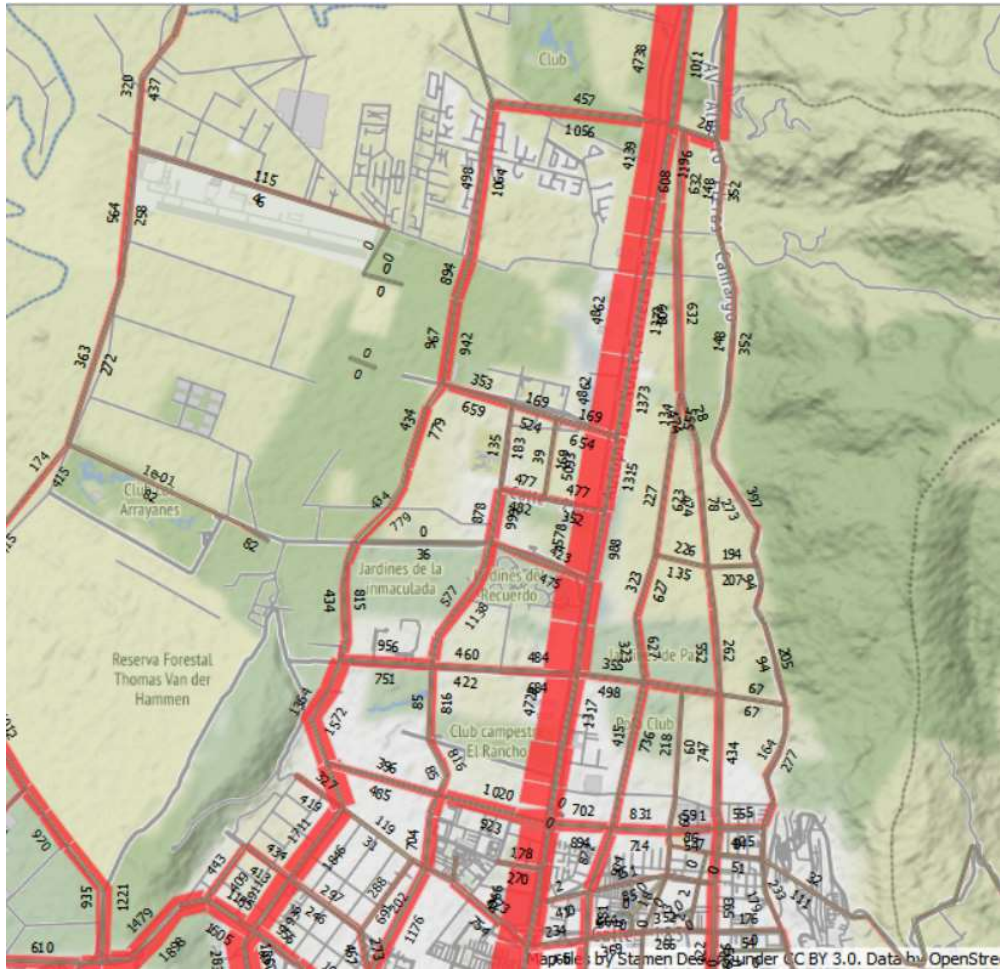
Figura 43. Asignación con proyecto para demanda escenario 2030. HP A.M. Fuente: HMV Ingenieros (2019) obtenido con la simulación por el software EMME
